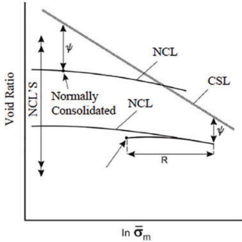
Fig. 7. State parameter in NorSand model.
