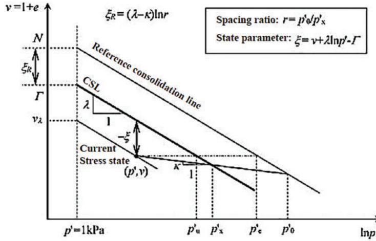
Fig. 4. CASM parameters ( $e$ ,  $r$ ,  $G$ ) [8].
