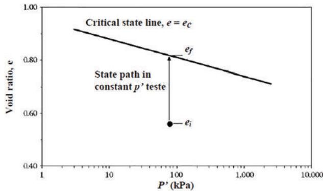
Fig. 8. Definition of the state parameter ( $\psi$ ) [4].
