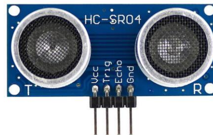
Fig. 6. Ultrasonic distance sensor HC-SR04).
